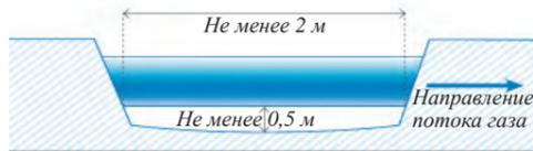
и приступают к выемке грунта в месте расположения дефекта. Затем участок трубы очищают от изоляции для идентификации повреждений и подготовки к обследованию с помощью неразрушающих методов контроля. Изучение газопровода позволяет уточнить наличие, характер, размеры коррозионных и механических изъянов и определить способы устранения дефектов.
