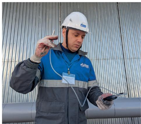
Замер толщины лакокрасочного покрытия трубы
