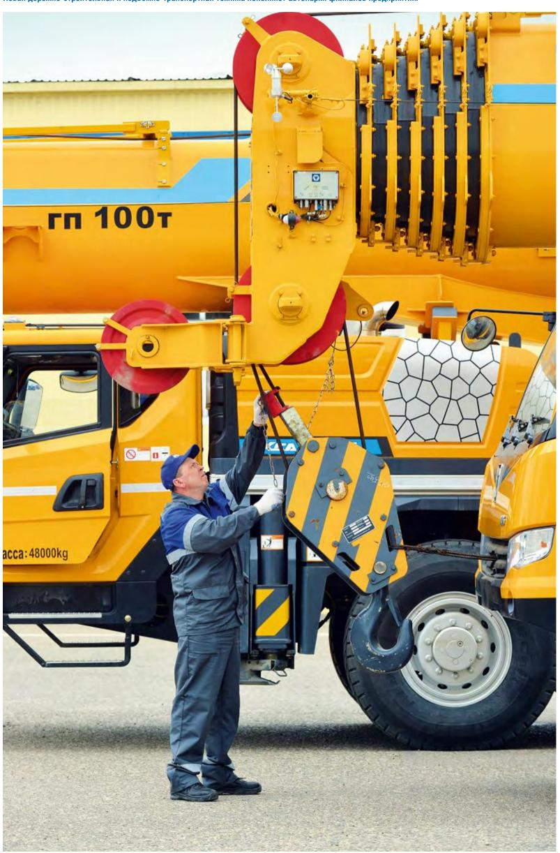
ятая автоколонна УТТиСТ первой в Обществе получила два стотонных крана китайского производства. Это мобильные колесные машины. Они сконструированы с использованием принципиально новой гидравлической системы, которая получила в Китае шесть государственных патентов. Эти автокраны показывают отличную проходимость и маневренность.
