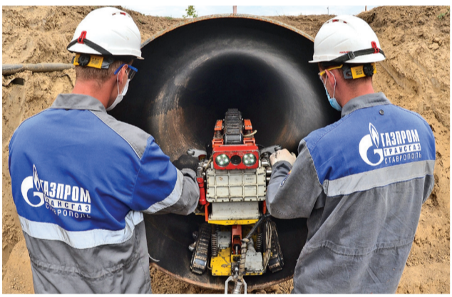
Регулярная диагностика позволяет газовикам тщательно следить за техническим состоянием газотранспортных объектов и работать на предупреждение. Использование роботизированных телеуправляемых систем даёт возможность работникам «Газпром трансгаз Ставрополь» удалённо инспектировать километры подземных газовых коммуникаций.
