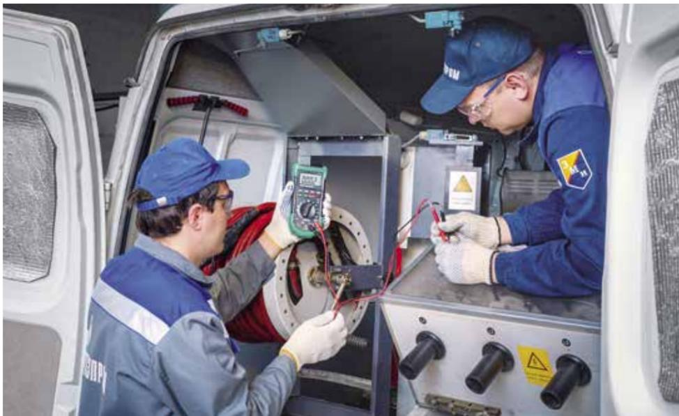
Проверка работы соединений между блоками установки
