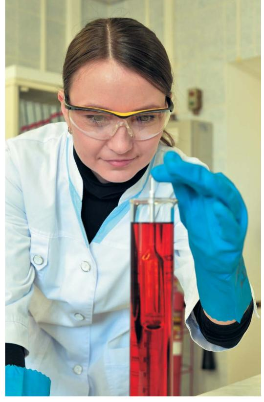
Масляную жидкость, отработавшую в газоперекачивающем агрегате, специалист наливает в цилиндр и начинает процедуру исслелования.
