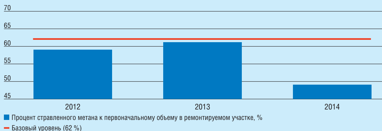
ДИНАМИКА ОТНОШЕНИЯ СТРАВЛЕННОГО ОБЪЕМА ГАЗА ПРИ ПРОВЕДЕНИИ РЕМОНТА МАГИСТРАЛЬНОГО ГАЗОПРОВОДА (МГ) К НАЧАЛЬНОМУ ОБЪЕМУ ГАЗА В МГ ПЕРЕД ПРОВЕДЕНИЕМ РАБОТ, %
