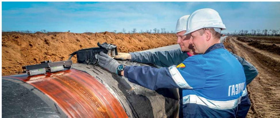
Проведение ультразвукового контроля сварного соединения
