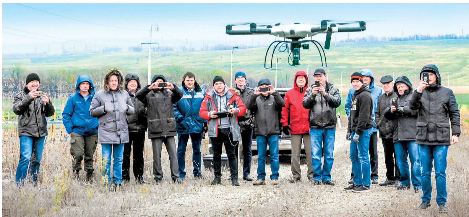
Старт квадрокоптера с портативным лазерным детектором метана
