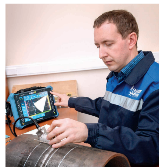
Ультразвуковой контроль сварных стыков
