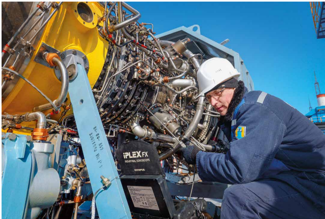
Визуально-оптическая проверка двигателя
