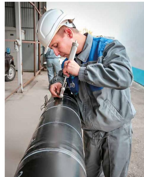
Контроль адгезии изоляционного покрытия
