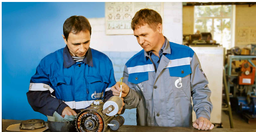
Александр Ярошенко контролирует качество ремонта электродвигателя
