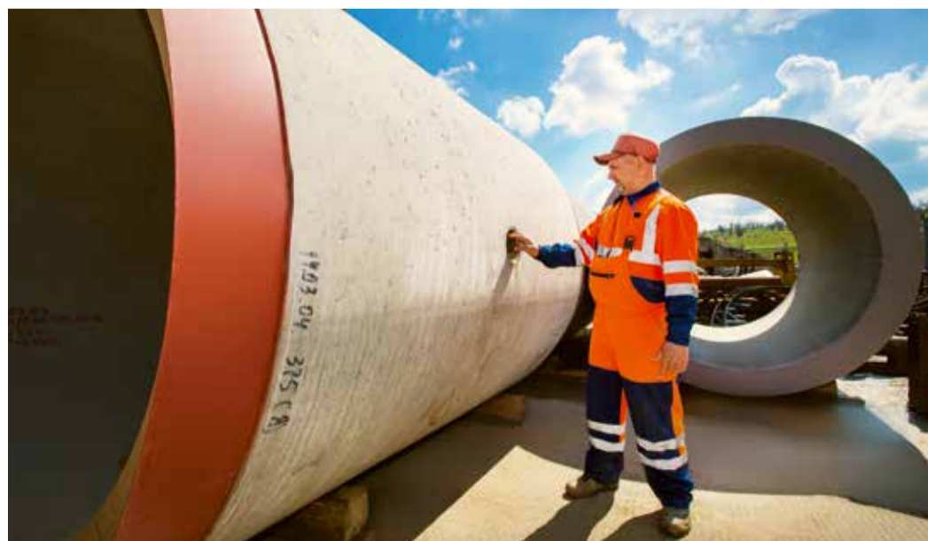
Входной контроль микротоннельной трубы
