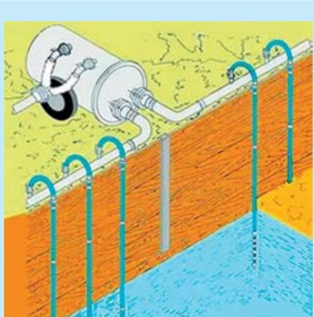
Иглофильтровая установка представляет собой комплект оборудования, позволяющий при помощи насосного агрегата откачать воду из почвы и тем самым временно понизить уровень грунтовых вод.
